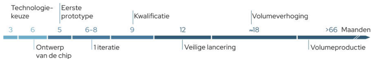
Fig. 4.5: Illustratieve levenscyclus voor de automobielinindustrie: Analoog/gemengd-sigitaalproducten zijn veel gespecialiseerder voor hun toepassingen en worden vele jaren gebruikt.
