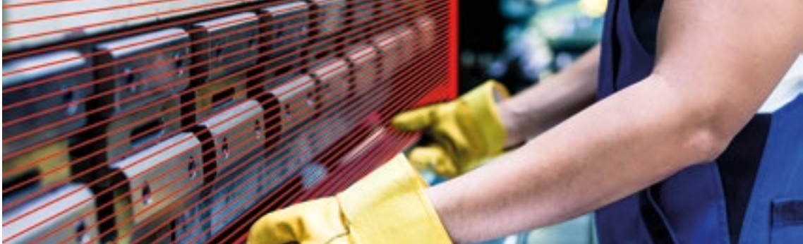
Figuur 4.5: Gereedschapsmachine met lichtgordijn ter bescherming van de bediener
